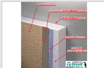
**湿式外断熱システム「アウサレーション」**
