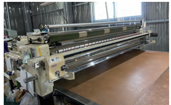
裁断時に使用する延反機。裁断する生地を真っすぐに伸ばしつつ重ねていく「延反」という工程を自動で行う。工場の設備の1つ
